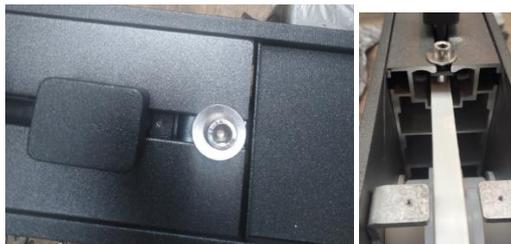
3. Desserrer la vis de blocage du chariot de freinage.
