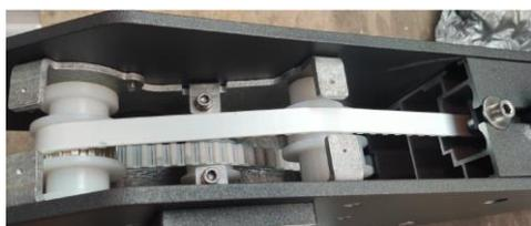
7. Enrouler la nouvelle courroie de distribution sur le mécanisme de pivotement du support de la barre de guidage et sur le mécanisme du capuchon de la barre de guidage.
