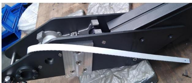
6. Tourner (dévier) le support de la barre de guidage pour enrouler la nouvelle courroie de transmission. Desserrer les vis qui bloquent le capuchon à l'avant de la barre de guidage (vis dans le creux de la rainure latérale de la barre).
