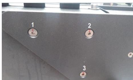
5. Desserrer les deux boulons supérieurs reliant les supports de la barre de guidage (n° 1 et 2) et desserrer le boulon inférieur (n° 3).
